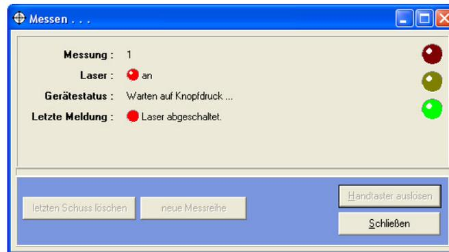
Nachdem alle Messungen einer Messreihe abgeschlossen wurden kann die nächste Messreihe bei **1.** beginnend gestartet werden. Jetzt können Sie die Messung auch beenden ohne dass die bisherigen Messungen verworfen werden, da die Messreihe abgeschlossen ist. Alle für diese Messreihe verwendeten Zeitvorgaben werden mit abgespeichert, um bei einer späteren Auswertung die Original – Bedingungen vorzufinden, unter denen die Messung durchgeführt wurde.
